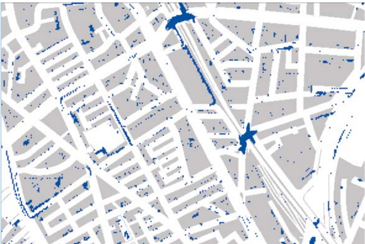
Karte der Überflutungsverdachtsflächen, auf denen sich bei einem extremen Niederschlagsereignis ein Wasserstand von mehr als 20 cm einstellen kann
